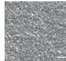
Coupe transversale de Reflectys au microscope à balayage électronique x 10 000
